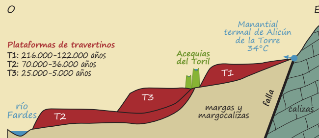
Figura 65. El manantial de Alicún de las Torres está asociado a una falla por donde asciende el agua termal. Este agua cargada de carbonato cálcico produjo la formación de las acequias del Toril y de las tres plataformas de travertinos (T1, T2 y T3) desde hace unos 216.000 años (Foto: Google Maps).
